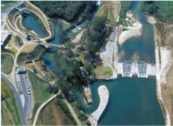
▲嘉瀬川から佐賀城下へ水を取込む巨大取水施設「石井樋」 その完成により、洪水被害は減り、佐賀城下の水不足は解消された (画像提供:筑後川河川事務所)
